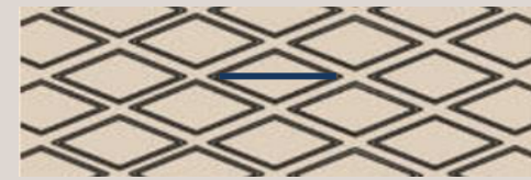
Chequer pattern acc. DIN 59220
